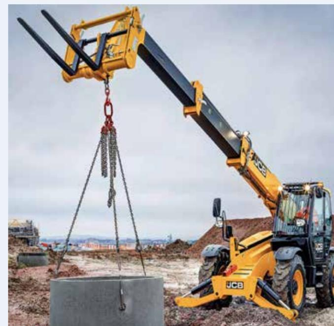
**IL GANCIO:** omologato con sicura, acciaio legato ad alta resistenza. Portata sino a 4.500 Kg. Utilissimo in edilizia e per la movimentazione di materiale nei cantieri.
