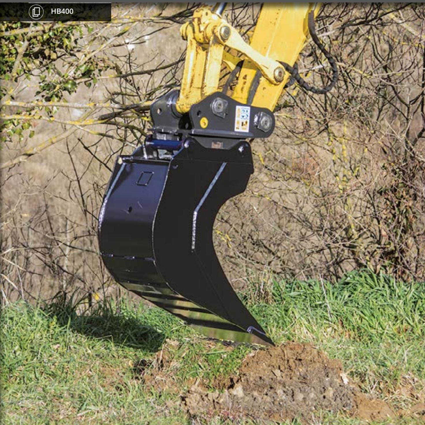
LA SUA FORMA ALLUNGATA EVITA CHE IL TERRENO ADERISCA ALLE PARETI LATERALI DELLA BENNA AGEVOLANDO LO SCARICO DI MATERIALI ARGILLOSI E BAGNATI. LE FIANCATE INCAVATE FACILITANO LE OPERAZIONI DI ATTRAVERSAMENTO DI IMPIANTI IDRAULICI, GAS ETC. LA LAMA È IN HB400 PER UNA MAGGIORE RESISTENZA ALL'USURA.
