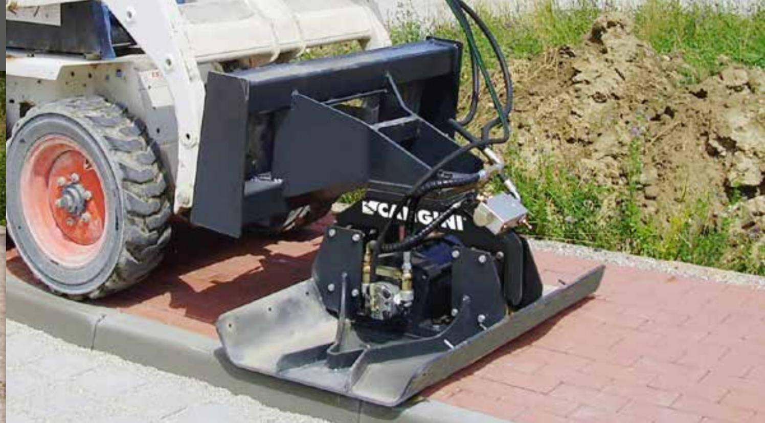
PROGETTATA PER COMPATTARE QUALSIASI SUPERFICIE, LA PIASTRA VIBRANTE RISULTA PARTICOLARMENTE UTILE PER LA COMPATTAZIONE DEL MATERIALE PER PAVIMENTAZIONI, FONDI STRADALI E PER LA CREAZIONE DI PISTE CICLABILI E MARCIAPIEDI. ASSICURANDO UN FONDO SOLIDO E OMOGENEO CHE DURA NEL TEMPO.
