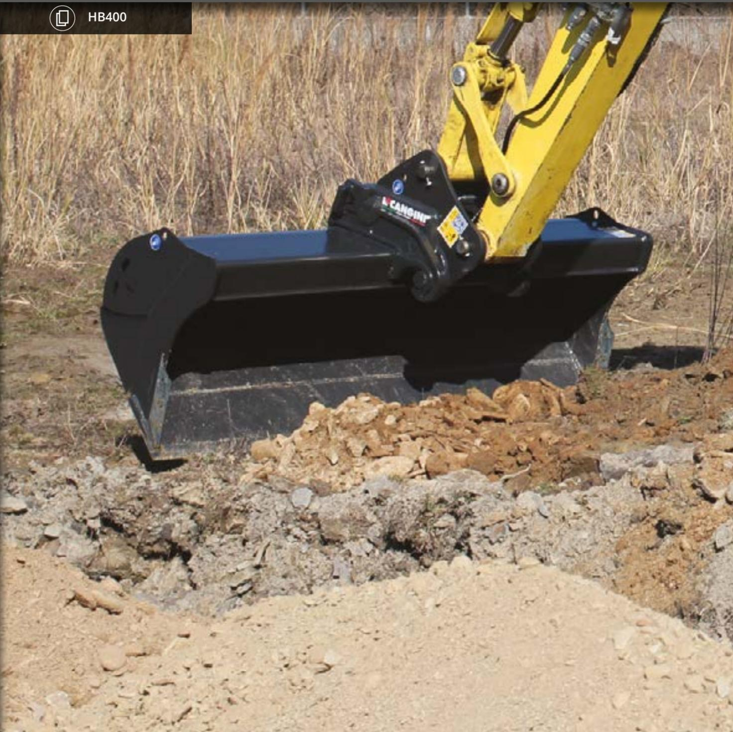
DOTATA DI RINFORZI IN HB400 NEI PUNTI DI MAGGIOR USURA, TAGLIENTI LATERALI REALIZZATI IN FUSIONE E SOTTOLAMA REVERSIBILE IMBULLONATA LA RENDONO ADATTA PER LAVORAZIONI SU TERRENI PARTICOLARMENTE ABRASIVI.
