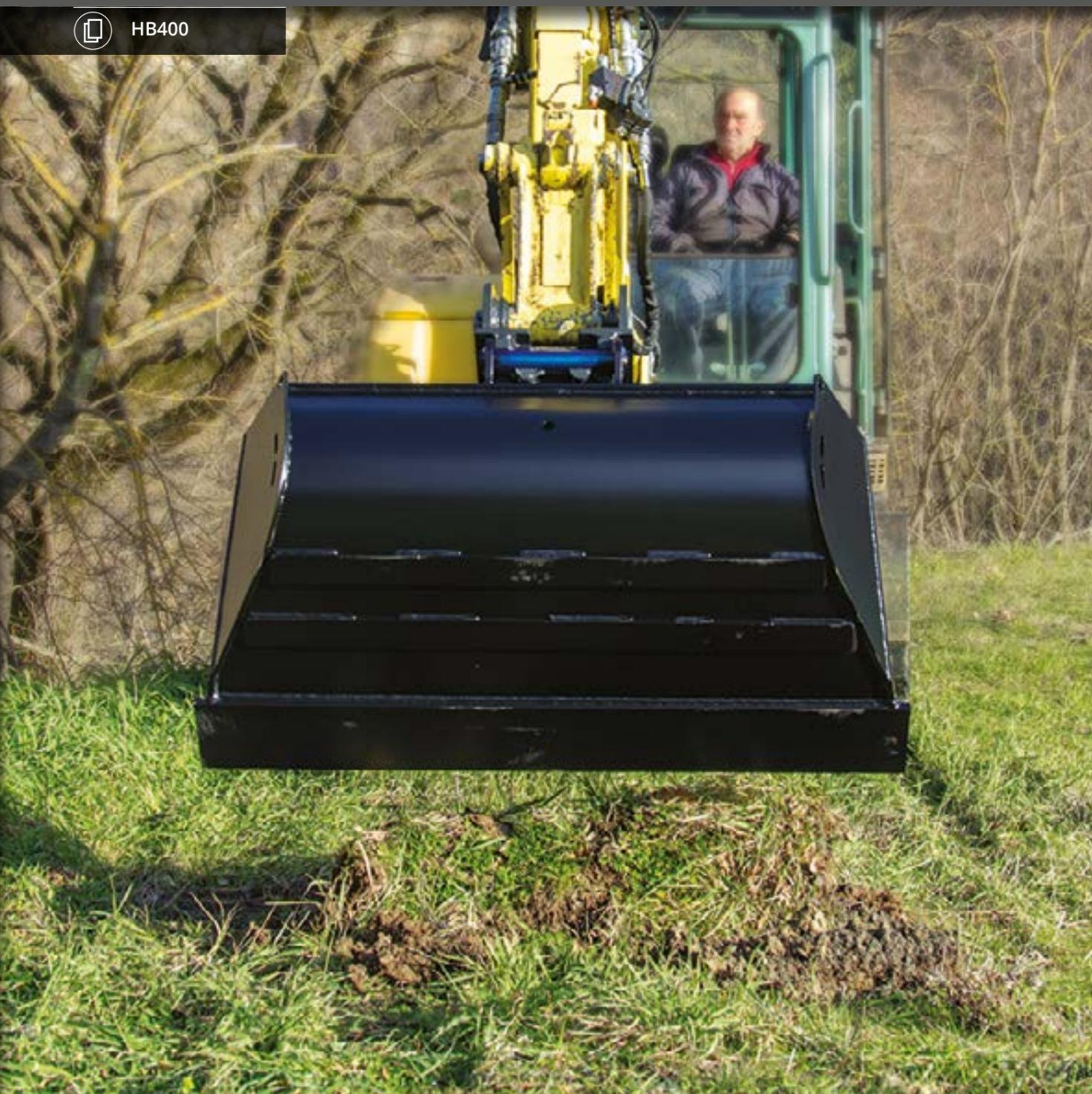
LA SUA FORMA SVASATA A 25° LA RENDE PARTICOLARMENTE ADATTA ALL'UTILIZZO IN COMBINAZIONE CON SISTEMA ROTOTWIST. LA PARTE POSTERIORE, CONICA A 25°, PERMETTE DI RUOTARE LA BENNA RIMANENDO ALL'INTERNO DELLO SCAVO SENZA ROVINARLO. LA LAMA È IN HB400 PER UNA MAGGIORE RESISTENZA ALL'USURA.
