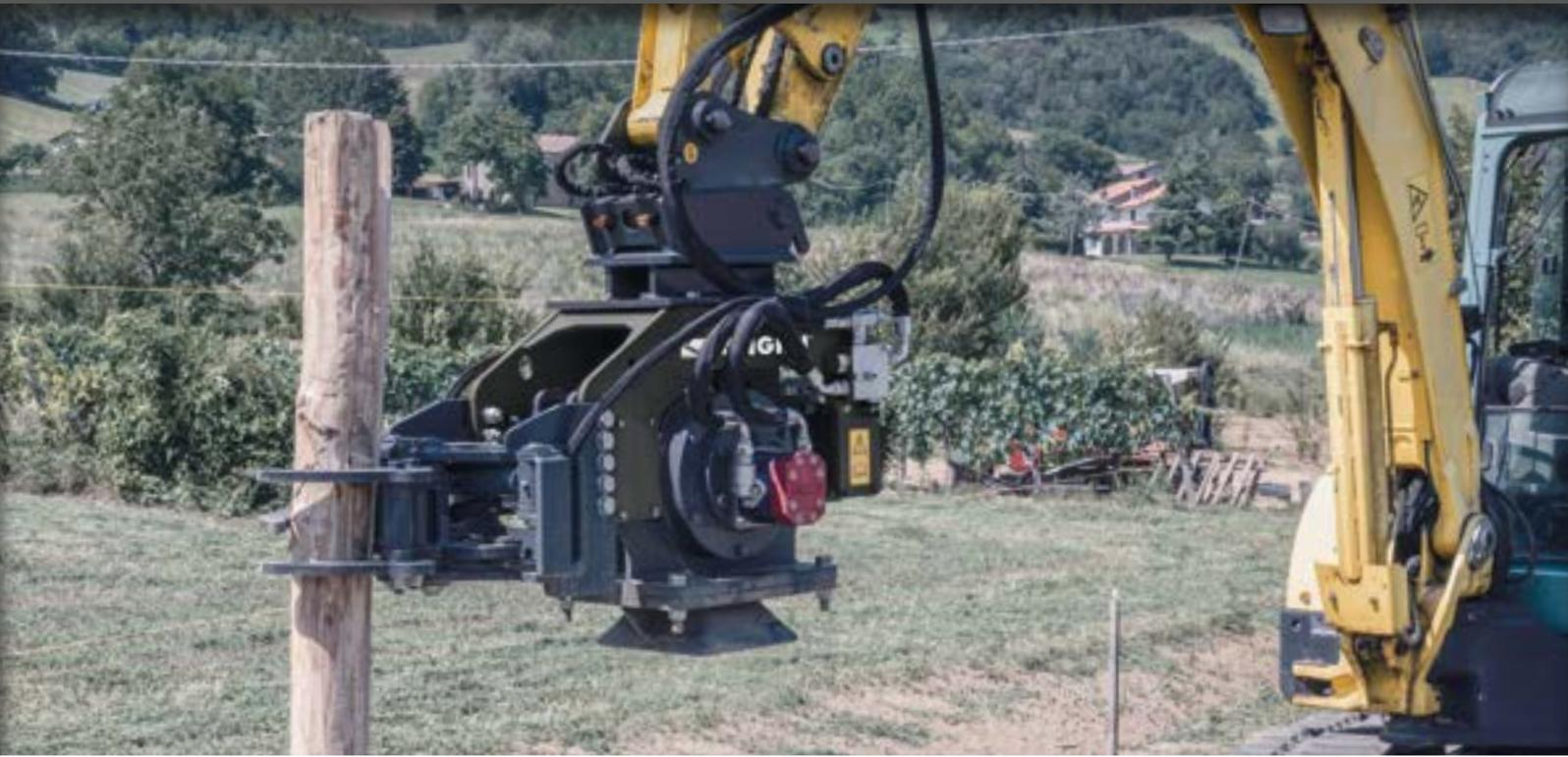
LE PIASTRE COMPATTATRICI POSSONO ESSERE EQUIPAGGiate DI KIT PER LA VIBROINFIESSIONE DI PALI - COLLARE CENTRA-PALO - E DI PINZA PER LA PRESA DEI PALI IN LEGNO O IN CEMENTO-ACCIAIO. QUESTO STRUMENTO COSÌ COMPOSTO È IDEALE NEI LAVORI DI CONTENIMENTO DELLE FRANE, PER CREARE RECINZIONI E, IN AGRICOLTURA, PER L'IMPIANTO DI VIGNETI E FRUTTETI E PER PREPARARE UNA SOLIDA BASE PER LA PAVIMENTAZIONE E PER MOLTI ALTRI IMPIEGHI SIMILI. L'ATTREZZATURA È COMPRESA DI ATTACCO FISSO ALLA MACCHINA.
