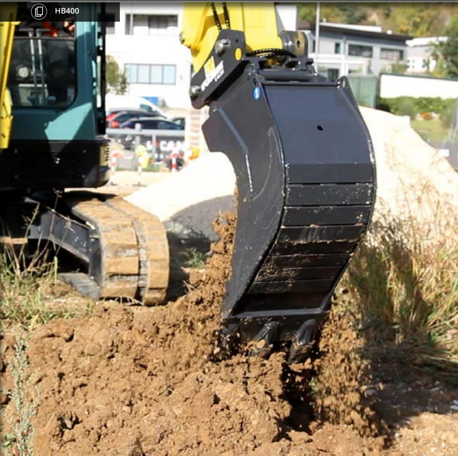
LA SUA FORMA ALLUNGATA EVITA CHE IL TERRENO ADERISCA ALLE PARETI LATERALI DELLA BENNA AGEVOLANDO LO SCARICO DI MATERIALI ARGILLOSI E BAGNATI. LE FIANCATE INCAVATE FACILITANO LE OPERAZIONI DI ATTRAVERSAMENTO DI IMPIANTI IDRAULICI, GAS ETC. È RINFORZATA IN TUTTE LE ZONE SOGGETTE A MAGGIOR USURA: LA LAMA, I TAGLIENTI IN FUSIONE, I RINFORZI LATERALI E LE FASCE DI RINFORZO POSTERIORI SONO IN HB400.
