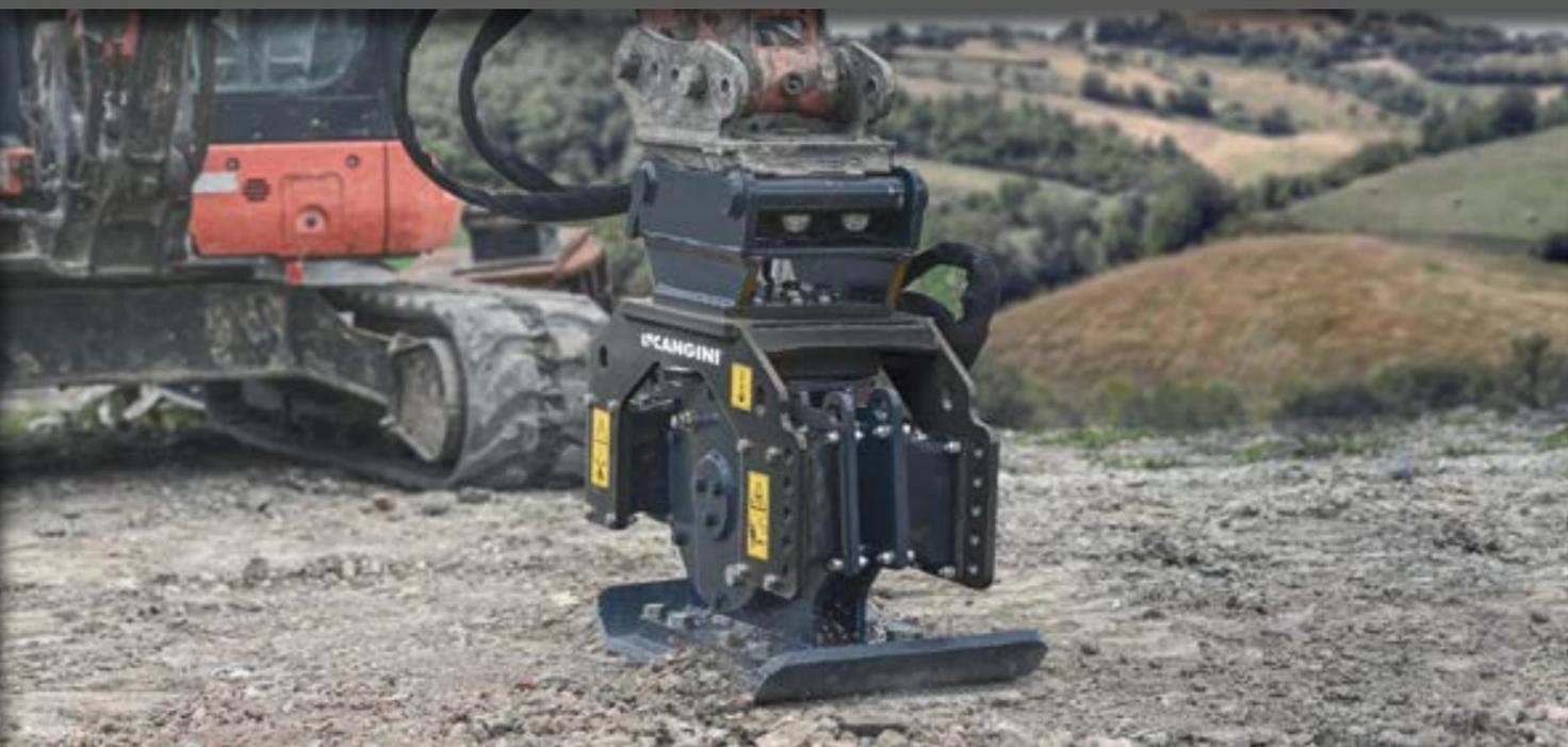
PROGETTATA PER COMPATTARE QUALSIASI SUPERFICIE, LA PIASTRA VIBRANTE RISULTA PARTICOLARMENTE UTILE PER LA COMPATTAZIONE DEL MATERIALE DI RIEMPIMENTO DELLO SCAVO A SEGUITO DELL'INTERRAMENTO DI CAVI E TUBI. ASSICURANDO UN FONDO SOLIDO E OMOGENEO CHE DURA NEL TEMPO. L'ATTREZZATURA È COMPRESA DI ATTACCO FISSO ALLA MACCHINA.
