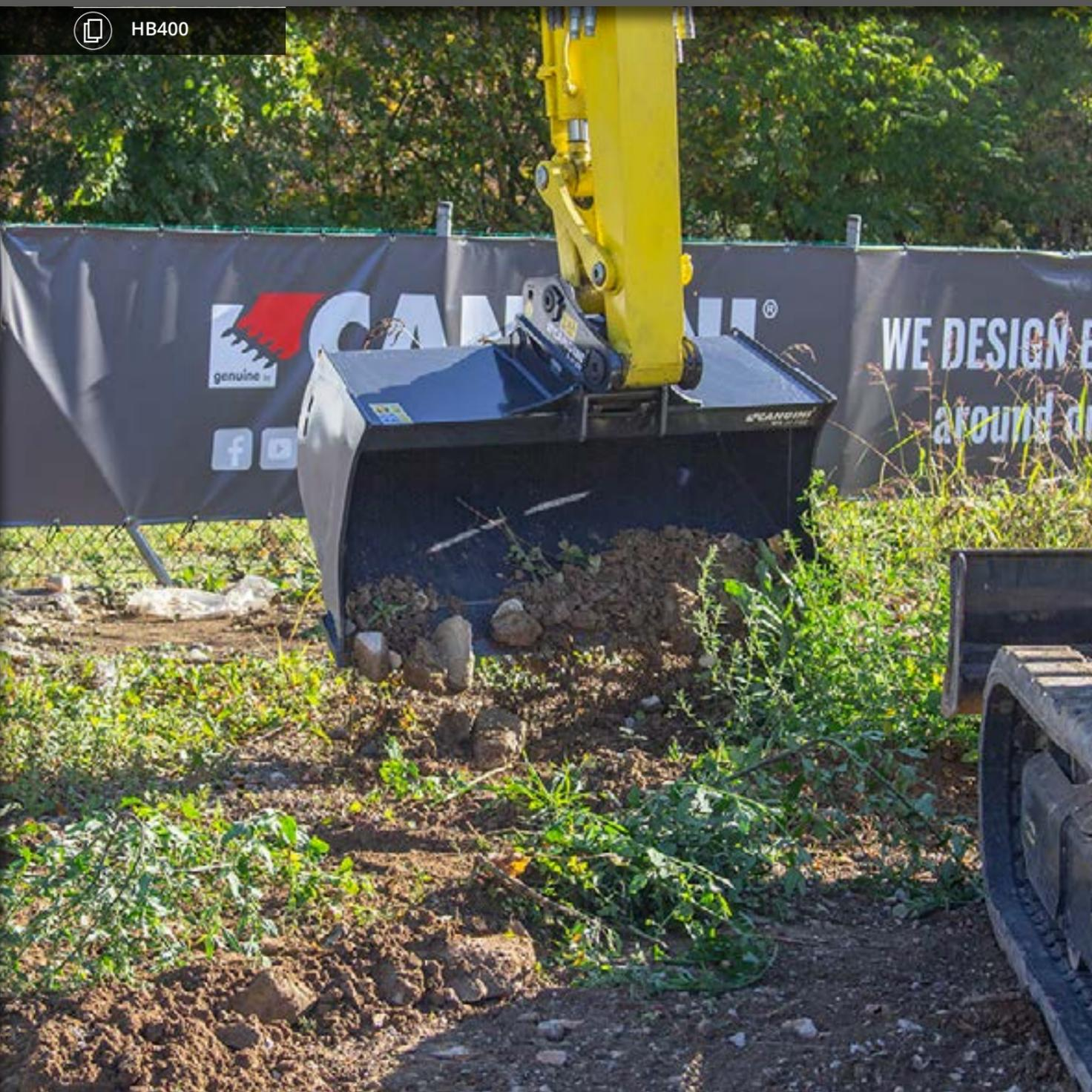
LA SUA FORMA SVASATA LA RENDE PARTICOLARMENTE ADATTA ALL'UTILIZZO IN COMBINAZIONE CON SISTEMA ROTOTWIST. LA PARTE POSTERIORE, CONICA A 8°, PERMETTE DI RUOTARE LA BENNA RIMANENDO ALL'INTERNO DELLO SCAVO SENZA ROVINARLO. LA LAMA È IN HB400 PER UNA MAGGIORE RESISTENZA ALL'USURA.
