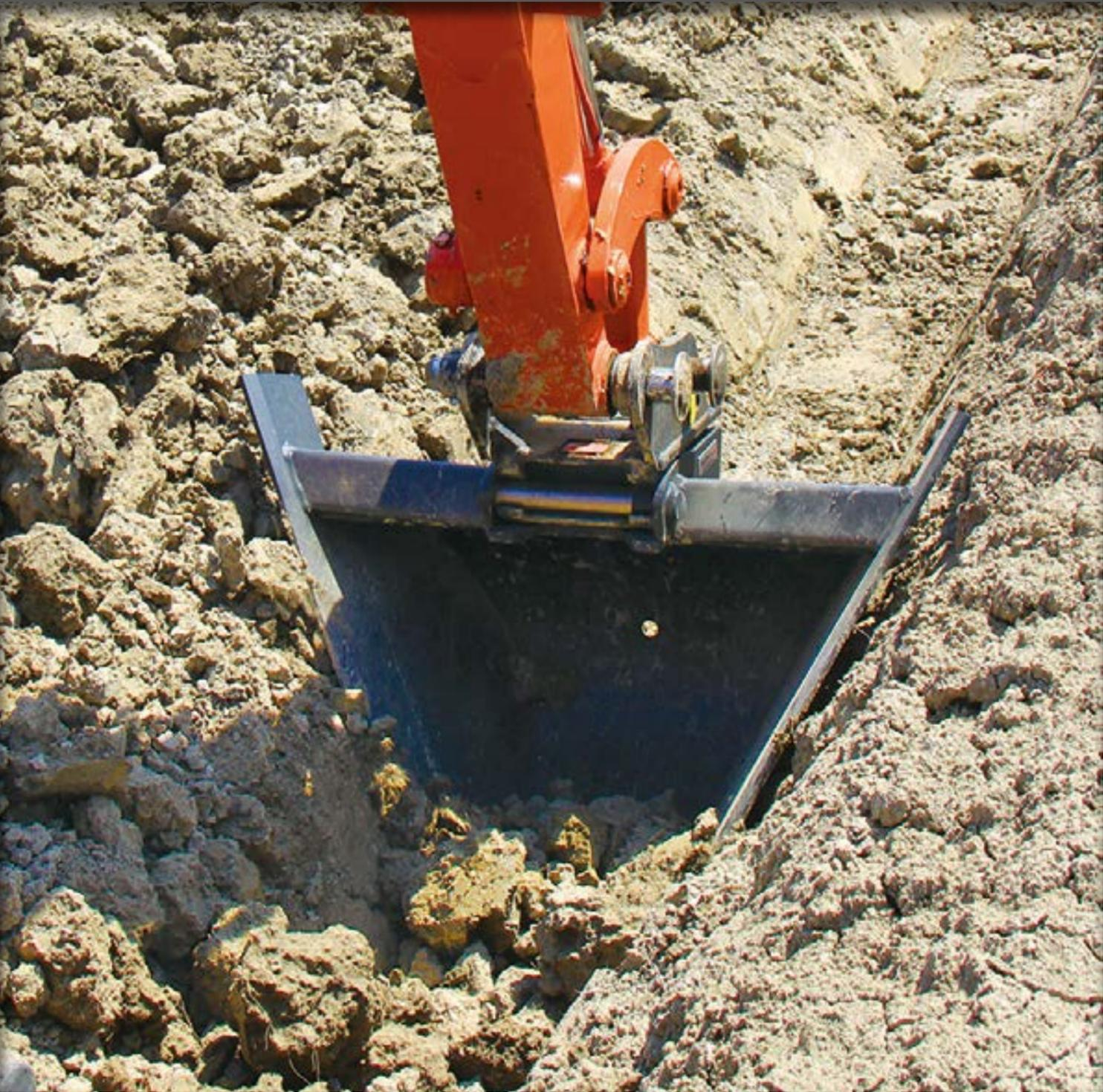
LA SUA FORMA A TRAPEZIO E LE POSSIBILI INCLINAZIONI DEI FIANCHI (52°-60°) PERMETTONO LA CREAZIONE E MANUTENZIONE DI FOSSI E CANALI DI DIVERSE DIMENSIONI E ANGOLAZIONI.
