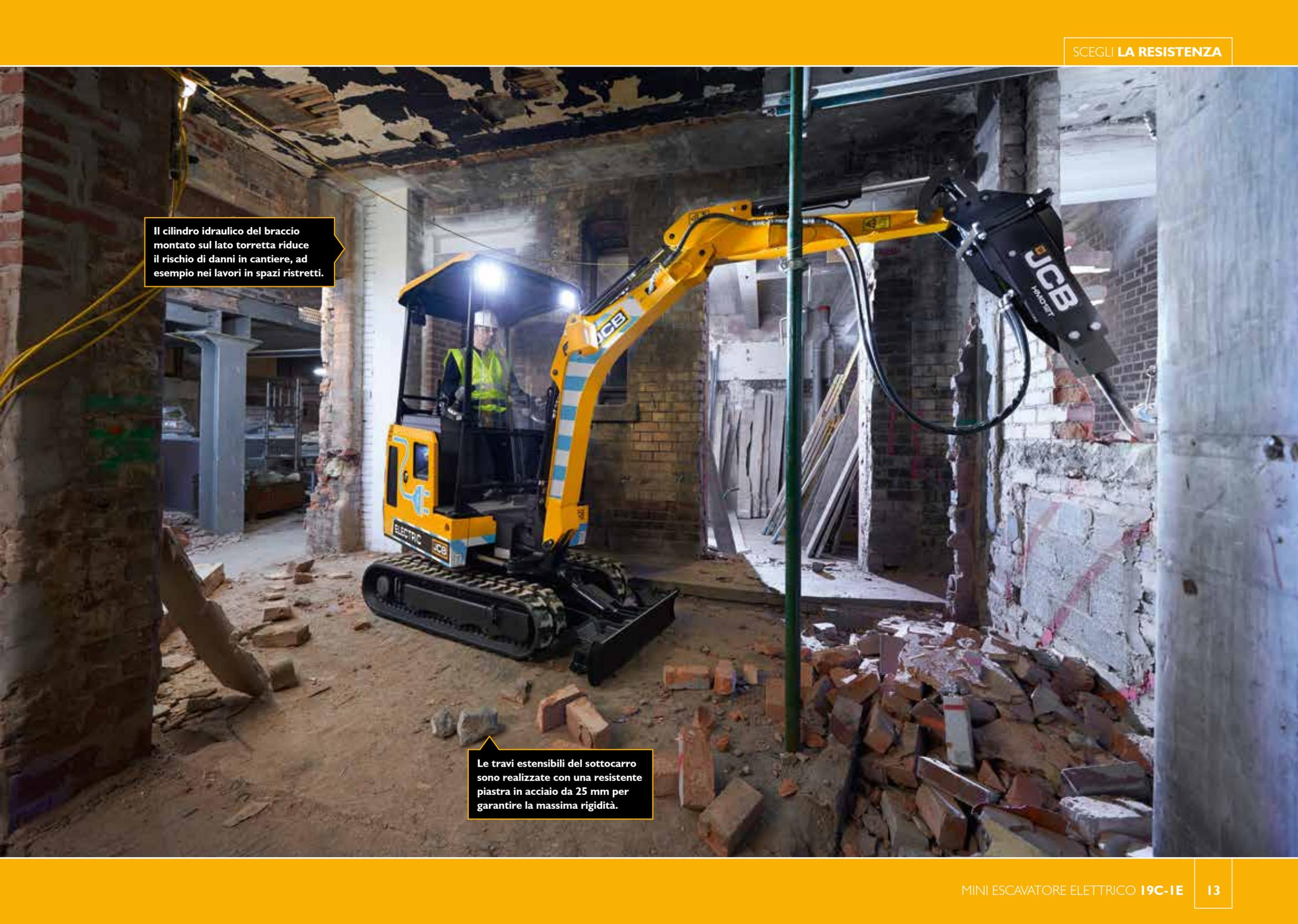
Il cilindro idraulico del braccio montato sul lato torretta riduce il rischio di danni in cantiere, ad esempio nei lavori in spazi ristretti.
