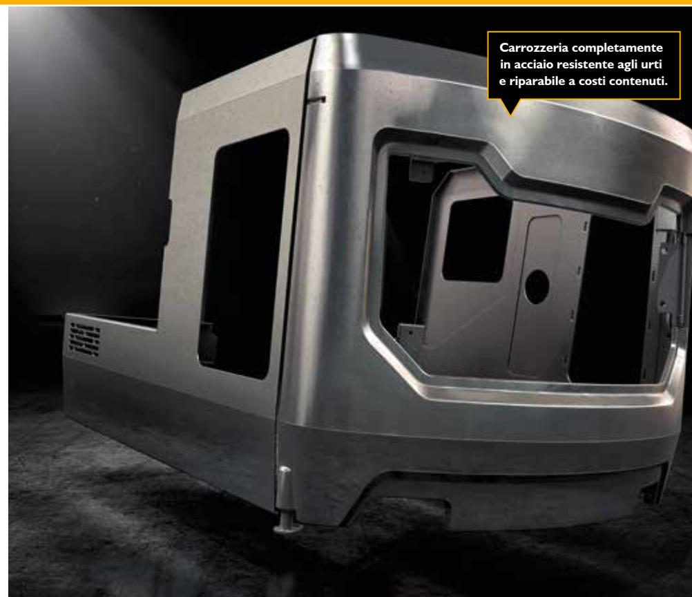
Carrozzeria completamente in acciaio resistente agli urti e riparabile a costi contenuti.
