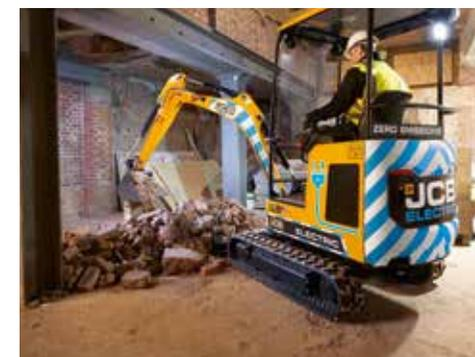
4 Il minimo automatico rende il lavoro semplice ed efficiente riducendo i giri al minimo quando la macchina non viene utilizzata, ottimizzando in questo modo l'uso della batteria.
