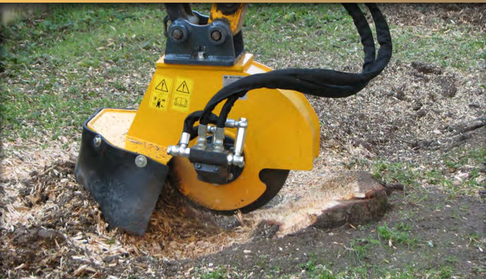
RAPIDA ED EFFICACE, L'ATTREZZATURA È UTILE PER LA FRESATURA DI CEPPI, BRANDEGGIANDO LA RUOTA DENTATA DA UN LATO ALL'ALTRO E AVANZANDO GRADUALMENTE NEL CEPPO FINO AD ELIMINARLO COMPLETAMENTE. IL SISTEMA DI TRASMISSIONE DIRETTA CON MOTORE A PISTONI FORNISCE LA MASSIMA VELOCITÀ DI TAGLIO E QUINDI UNA PRODUTTIVITÀ E UN'EFFICIENZA OTTIMALI. I DENTI IN TUNGSTENO DI CARBURO SONO ALTAMENTE RESISTENTI.
