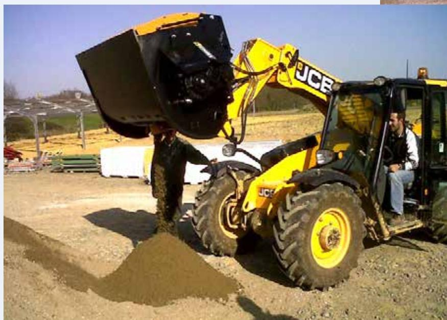
**BENNA MISCELATRICE:** per calcestruzzo con pale da 500 l, carica il materiale con la benna utilizzandola come pala. Scarica il materiale tramite la bocchetta ad apertura idraulica o tramite rovesciamento della benna. Utilissimo nell'edilizia.
