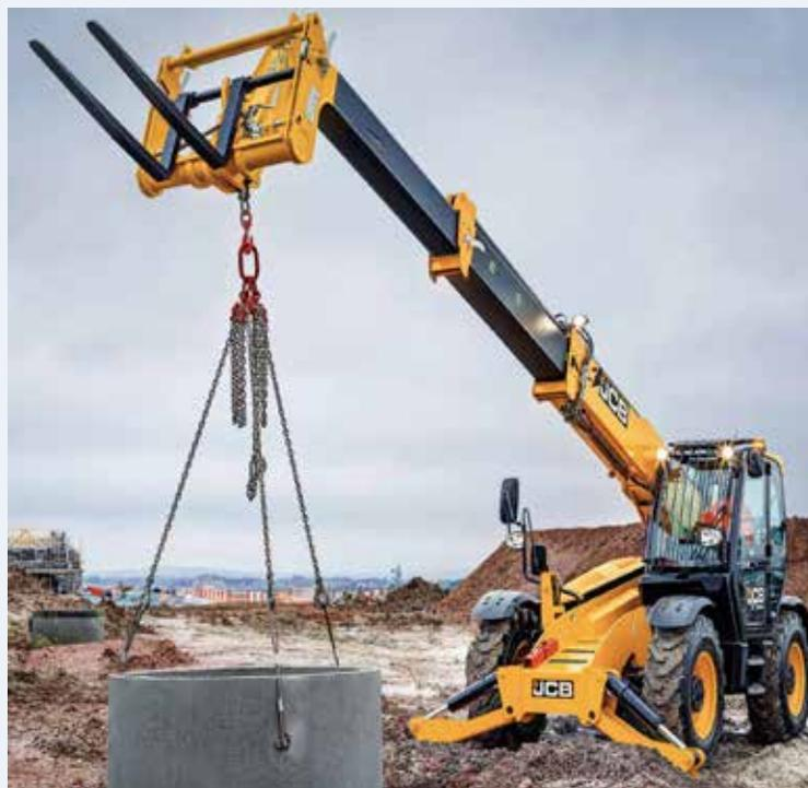
**IL GANCIO:** omologato con sicura, acciaio legato ad alta resistenza. Portata sino a 4.500 Kg. Utilissimo in edilizia e per la movimentazione di materiale nei cantieri.
